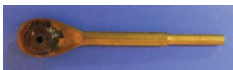
37. Wellenärmchen ohne Gewinde, Länge 52 Messing
