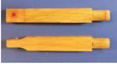
14. Wellenärmchen mit Zapfen Ø 6 Eiche, ausgetucht, 60
