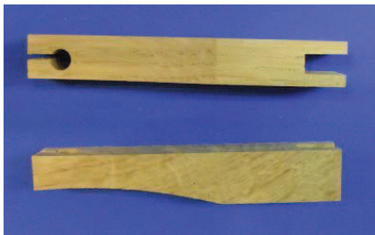
7. Ärmchen für Pedalwinkel Eiche, 90 x 15 x 12
